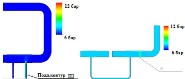
Рис. 3. Принцип работы подпиточного контура
